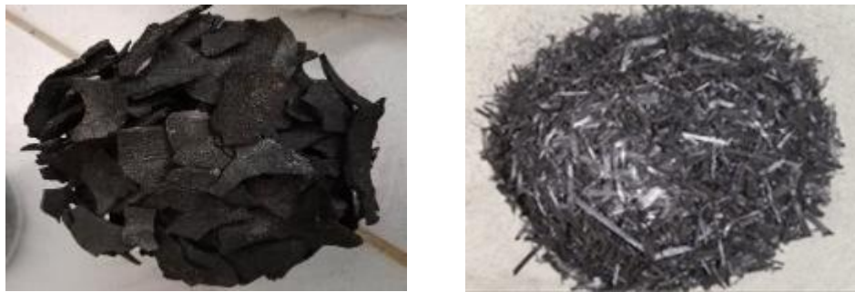
Gambar 2. 2 karbon aktif alami dari batok kelapa (b) karbon aktif sintetis dari bambu
