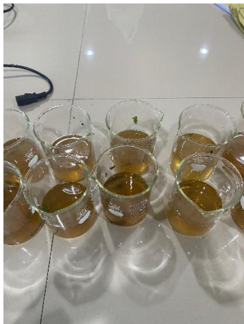
Keluarkan sampel dari dalam larutan NaCl dan diamkan kembali selama 30 menit
