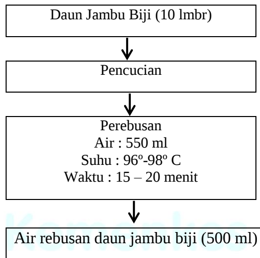
Gambar 3. 4 Diagram alir Perebusan Daun Jambu Biji
