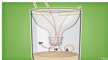
Gambar 2.6 Ilustrasi Kerja Alat Perangkap Nyamuk.
