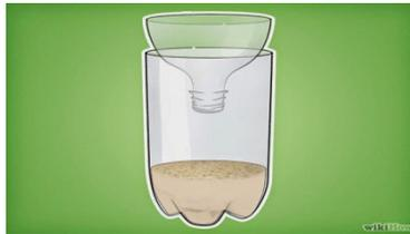
Gambar 2.5 Posisi potongan botol plastik bagian corong, letakkan terbalik kedalam separuh botol plastik
