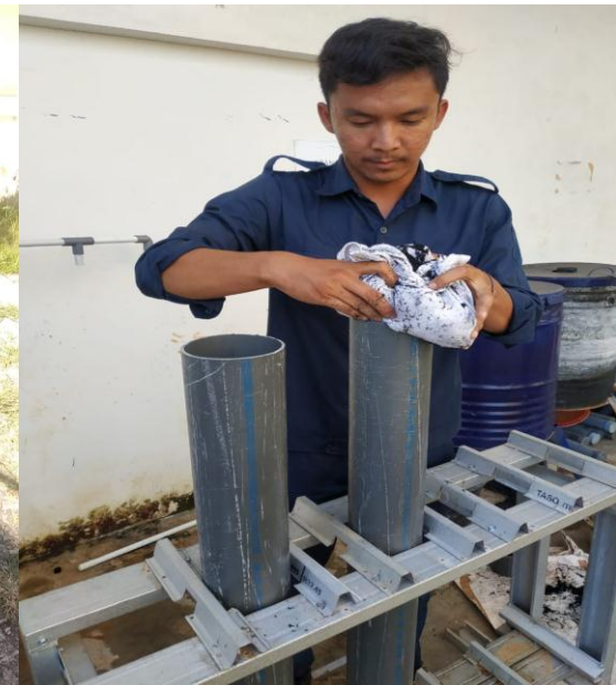
PROSES MEMASUKKAN ARANG AKTIF SEKAM PADI KE FILTRASI
