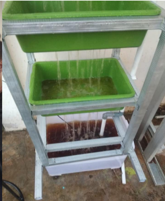
PENGISIAN AIR KE BAK PENAMPUNG TRAY AERATOR
