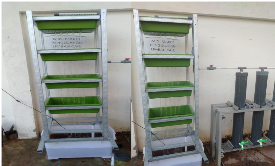
PROSES PEMOMPAAN AIR KE TRAY AERATOR
